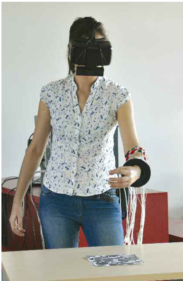
Masterstudentin Olga Mikhaylova testet die virtuelle Armprothese. Durch die Brille sieht sie anstelle der Handgelenksmanschette den virtuellen Arm.
