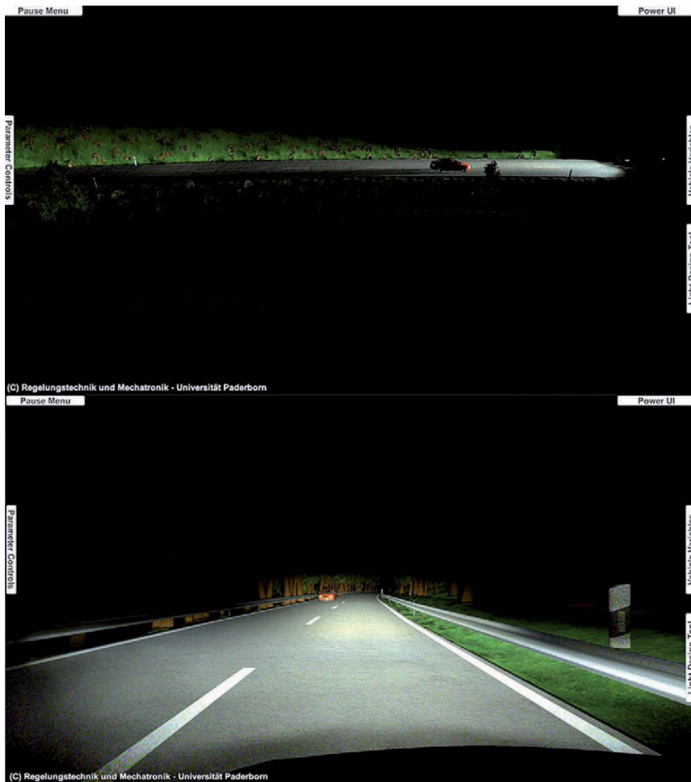
Simulation eines fiktiven HD-Scheinwerfersystems mit 1 200 Pixellichtern pro Scheinwerfer und Einblendung verschiedener Analysesichten (unten: Dimmwertdarstellung, oben: Lichtverteilungen bezüglich Polar- und Azimutwinkel, beides in Falschfarben) in „Hyperion“.
